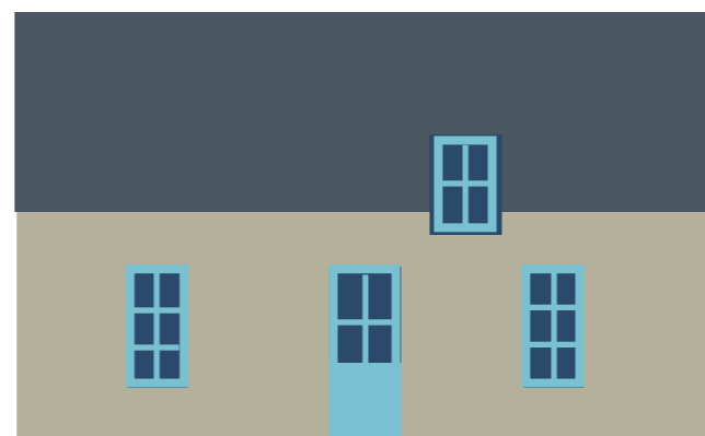
2- Installation de baguettes collées de même teinte Pour recréer les petits bois
